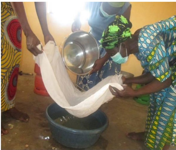
Figure 5 : Opération de filtrage du jus de pomme d'anacarde
