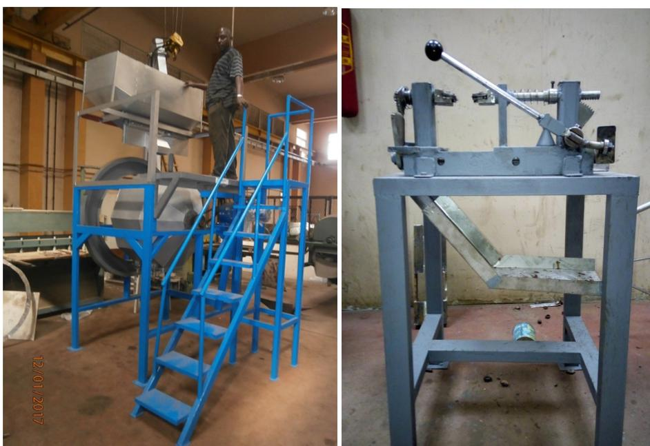
Figure 2: Cuiseur à Tambour rotatif et décortiqueur manuel développés dans le cadre du projet
